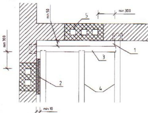
1. min. voľná bezpečná vzdialenosť 50 mm
